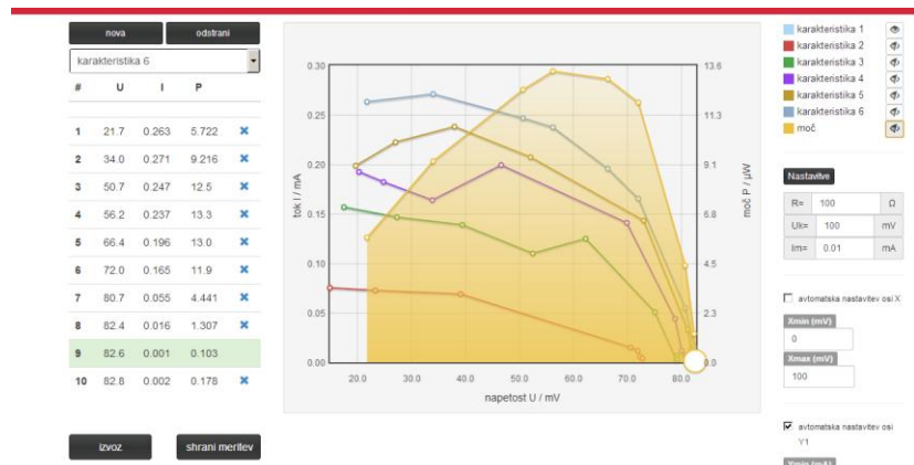
Slika 11. Primer izvedbe meritev s posebej izdelano spletno aplikacijo. Na sliki je več meritev I - U karakteristike sončne celice ob različnih osvetlitvah v odvisnosti od bremena, priključenega na sončno celico. Iz zadnje izmerjene I - U karakteristike je izračunana moč ( U \cdot I ), ki je prikazana s krivuljo, pod katero je površina obarvana in za katero velja desna navpična os. Lepo se vidi, pri kateri napetosti je moč, prenesena na breme, največja.
